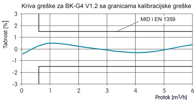
Kalibracione granice greške na laboratorijskoj temperaturi prema EN 1359:1998/A1:2006, Prilog B
